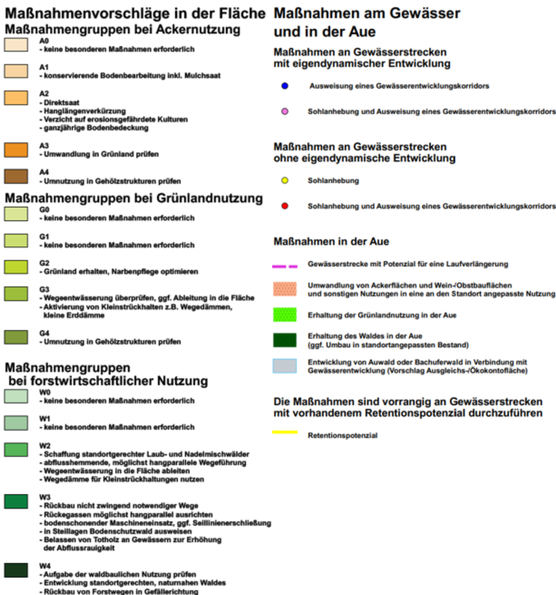
Abbildung 3: Maßnahmen für Flächen und Gewässer
